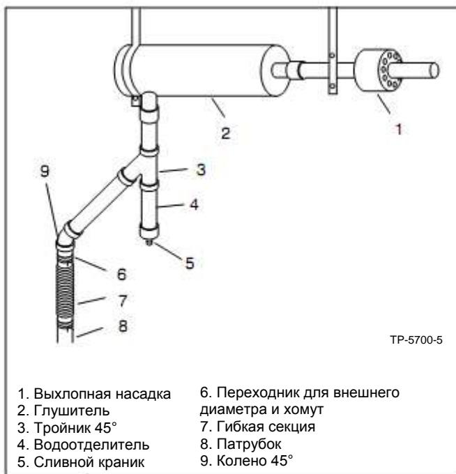
**Рисунок 5-2** Выхлопная система, боковой входной глушитель
