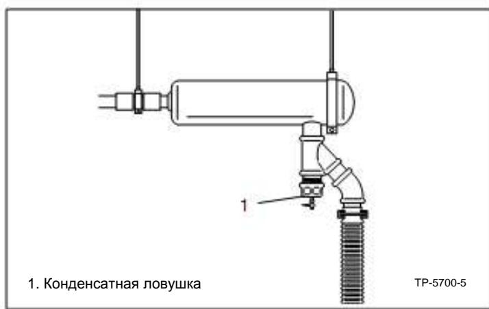
**Рисунок 5-4** Конденсатная ловушка
